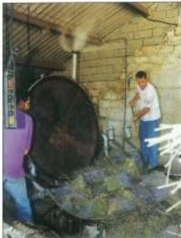
Abb. 2 Traditionelle Destillation: Der gebündelte Lavendel wird in Behälter gefüllt und mit Wasserdampf destilliert
